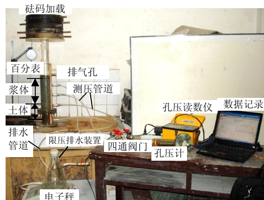
(b) 浆液固结变形试验装置试验照片
